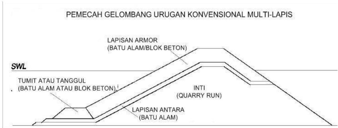
Gambar II.F.25 Pemecah gelombang urugan multi-lapis konvensional
