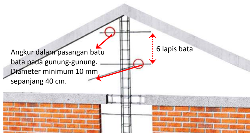
Gambar 52. Hubungan Angkur Pada Gunung-Gunung/ Ampig
