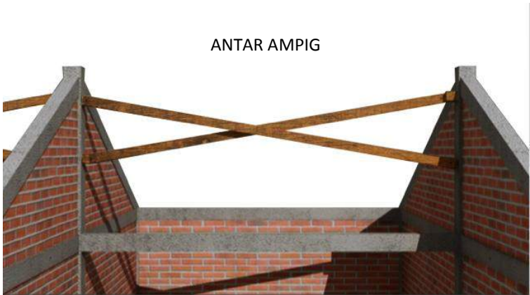
Gambar 35. Ikatan Angin Sebagai Pengikat Antar Gunung-Gunung/ Ampig
