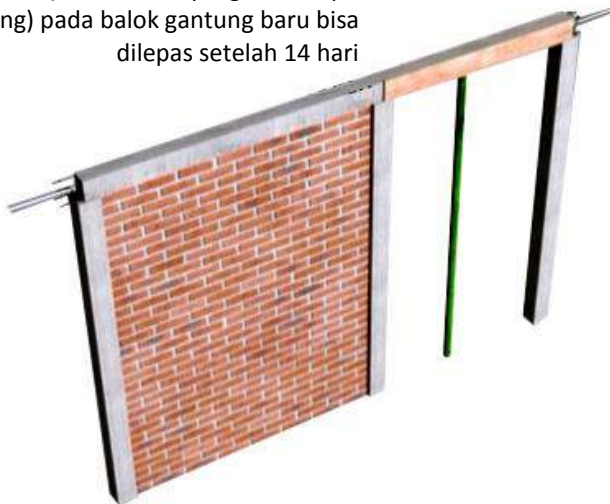
Gambar 61. Pelepasan Cetakan/ Bekisting
