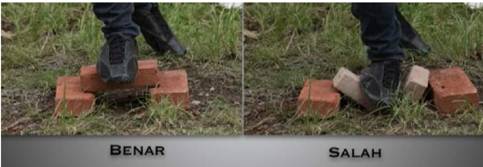
Gambar 13. Pengujian Sederhana Kekuatan Batu Bata
