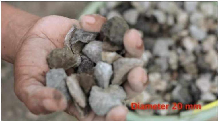
Gambar 5. Diameter Kerikil Yang Baik Untuk Campuran Beton
