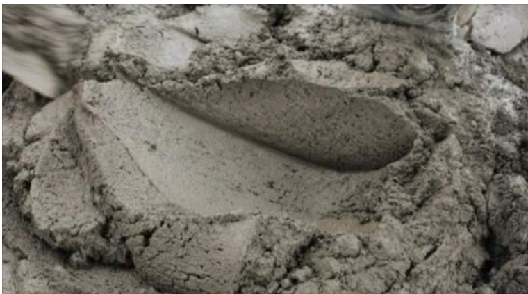
Gambar 9. Hasil Pencampuran Mortar Yang Baik
