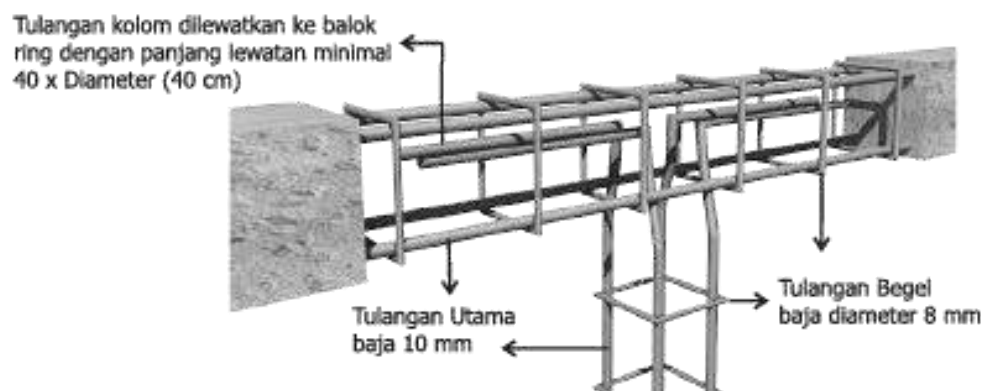
Gambar 48. Hubungan Anatar Kolom dengan Balok Keliling/ Ring
